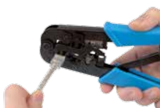
2 / Colocar el conector en la herramienta
