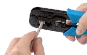
3 / Crimpar para terminar el conexionado
