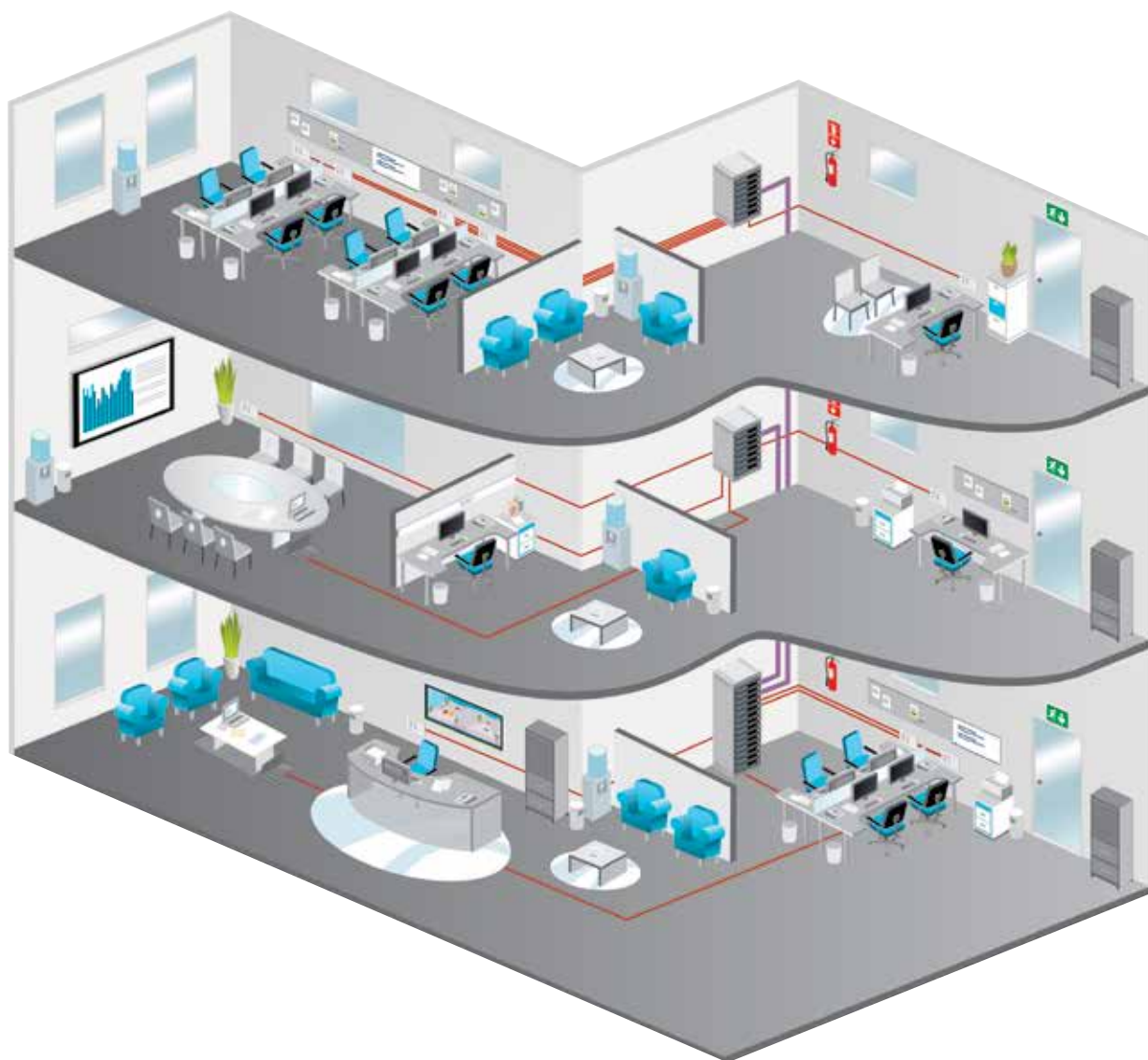
Estructura de una instalación de cableado estructurado
