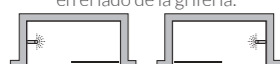
DCHA: Apertura de derecha a izquierda IZQ: Apertura de izquierda a derecha
